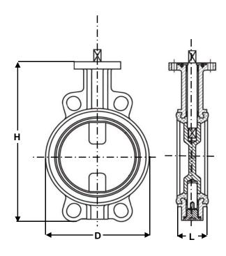
Montage entre brides PN10/16 et 150LBS du DN40 au DN400 inclus Montage entre brides PN10 à partir du DN450
