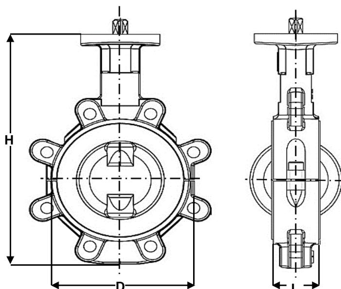
**Montage entre brides PN10/16 jusqu'au DN150, PN10 au-delà.**
